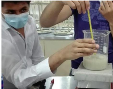
Figura 2. Incremento de Temperatura sobre un Fluido Fracturante.
