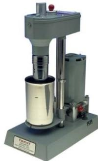
Figura 1. Test Comportamiento Reológico de un fluido fracturante.
