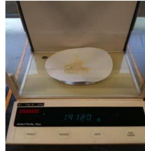
Figura II. Dsecado de la muestra y Cuantificación de sólidos totales.
