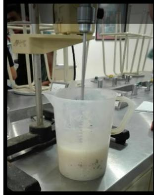
Figura 1. Acondicionamiento del Fluido Fracturante en reposo.
