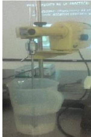
Figura 2. Hidratación del polímero en el agua de mezcla.
